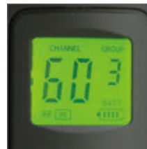
디지털 LCD 내장 채널, 그룹, 송신출력 (HI/LO), 배터리상태 표시
