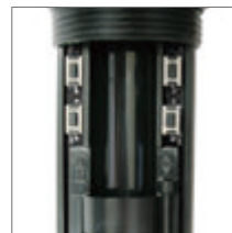
기능 선택 스위치 배터리 하우징에 내장된 4개의 menu(기능선택 버튼), set(설정 버튼), up(올림 버튼), down(내림 버튼) 스위치로 구성됩니다.
